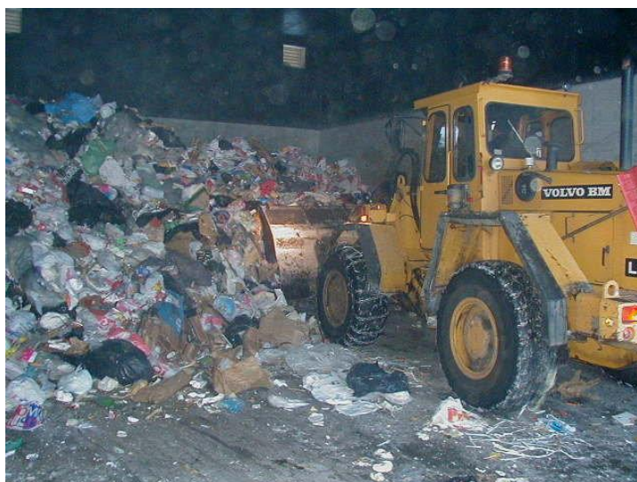
Bild 9: Lagerutrymmet måste tömmas för att inte nedbrytningsprocesser ska starta som utvecklar gaser.
